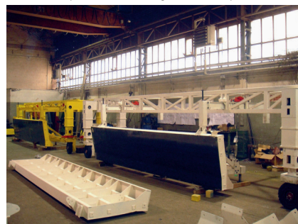
Cassaforma per murette della galleria di rampa
